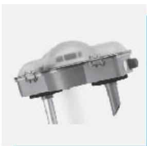
Die **Lüftungs- Rauchschalter- Systeme** LRS 01, LRS 02 und LRS 03, LRS 230 V DIBt, LRS 04 Ex und LRS 05 können auf runden, wie auch auf eckigen Lüftungskanälen eingesetzt werden. Der optische Rauchschalter im Inneren des LRS verfügt über eine intelligente Auswerteelektronik, eine automatische Messkammerüberwachung, Alarmschwellennachführung sowie eine von außen sichtbare Betriebsanzeige.
