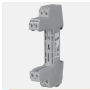
**BLITZDUCTOR XT-Basisteil** als sehr platzsparende, vierpolige, universelle Durchgangsklemme zur Aufnahme eines Ableiter-Moduls ohne Signaltrennung. Die sichere Erdung des Ableiter-Moduls wird über den Hutschienen-Tragfuß mittels einer Schnappbefestigung hergestellt.
