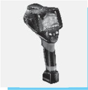
Die neue **Super-Resolution**-Technologie von TESTO verbessert die Bildqualität bei der Auswertung um eine Klasse. Bei jeder Aufnahme wird eine Sequenz von vier Bildern gespeichert, aus der ein höher aufgelöstes Bild berechnet wird. Es handelt sich also um kein Interpolationsverfahren, vielmehr werden Messwerte berechnet, die vergleichbar mit einer um den Faktor 4 größeren Pixelauflösung sind.
